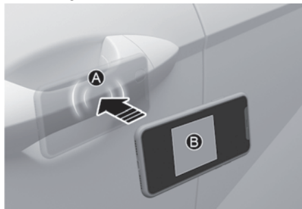
[A] Podloga za autentikaciju na kvaki vozila [B] NFC antena
